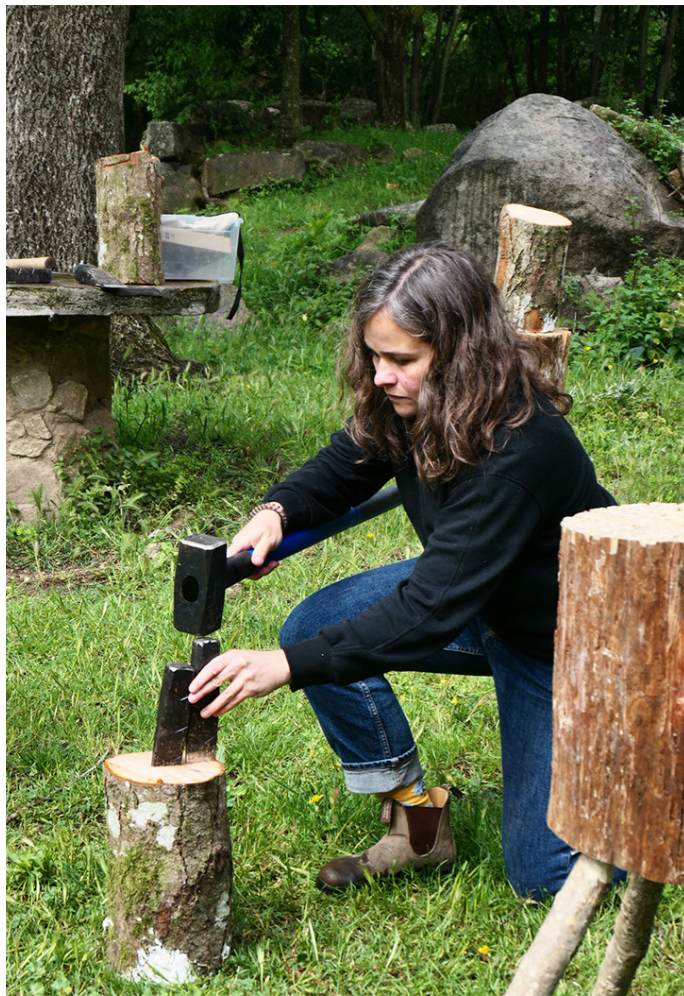
Aquí, Andrea muestra su técnica para dividir troncos con una cuña y un mazo (izquierda) y un froe (derecha). Al dividir en lugar de cortar, todas las fibras de la madera permanecen intactas, lo que resulta en una pieza de madera más fuerte para comenzar a tallar.
