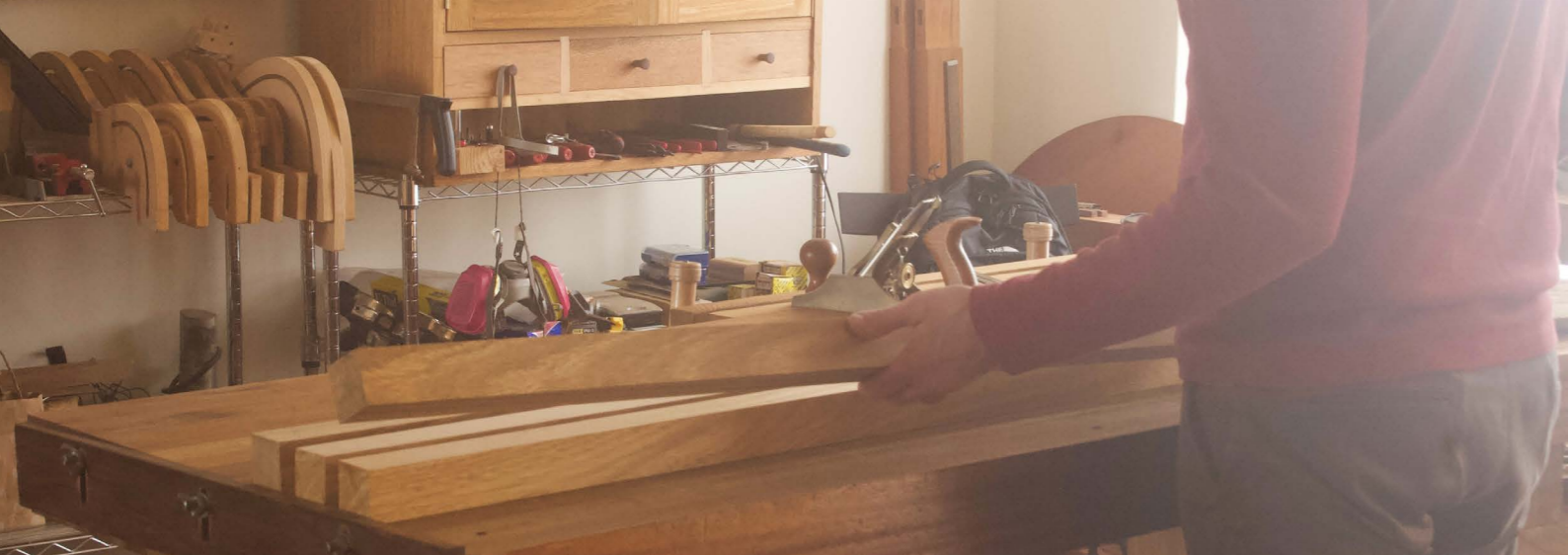
Selecciona las caras interior y exterior de las patas y orientalas tal como se integrarán en la estructura antes de marcar.
